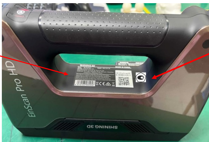
Рисунок 3 – Место расположения маркировочной наклейки с указанием заводского (серийного) номера прибора и место нанесения знака утверждения типа.
